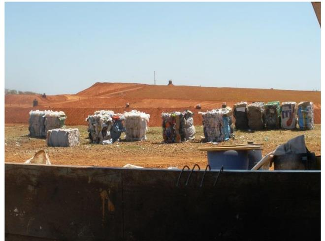
*Figura 5.11 – Material reciclável prensado e separado*
