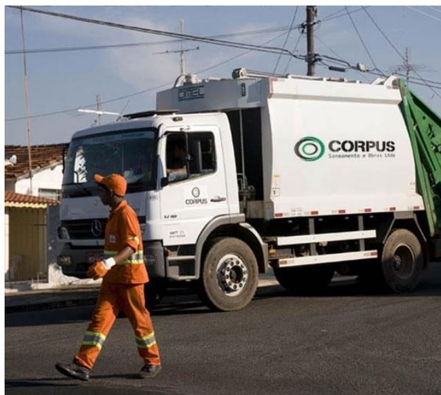
**Figura 5.1 – Caminhão coletor compactador**
