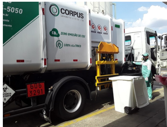
Figura 6.111. Vista do Caminhão Elétrico durante a Coleta de Grandes Geradores
